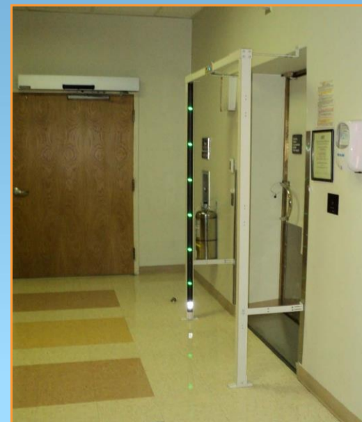
Рисунок 1. Ферромагнитный детектор, установленный на удалении от стены.
