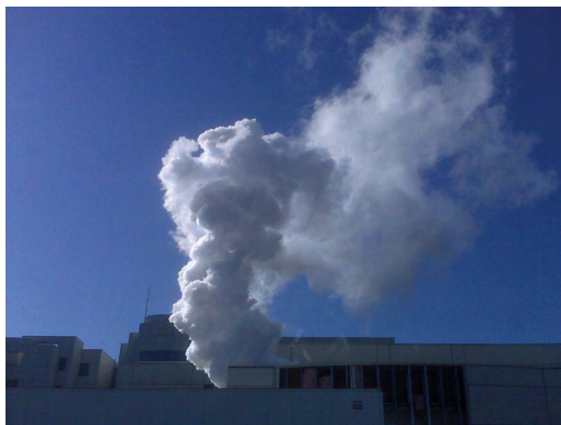
Рисунок 4 – Выброс гелия при квенче
